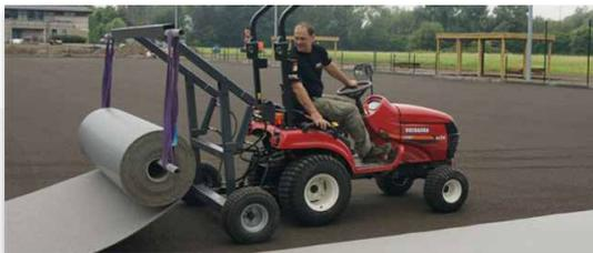
Le système de déroulement du gazon artificiel Henko 911 est conçu pour déplacer et dérouler le gazon artificiel. En utilisant ce système, vous déroulerez les rouleaux lourds plus rapidement, plus facilement et plus efficacement. Cela évitera en outre que l'équipe d'installation ne se blesse en manipulant des objets lourds. Extrêmement efficace et indispensable pour l'installation de terrains de football en gazon synthétique et autres grandes surfaces de gazon artificiel.
