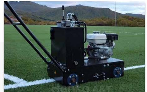
Le Grasshopper est développé pour exercer une pression sur les joints du gazon artificiel afin d'assurer une adhérence maximale de la colle. Cet appareil est autonome et différentes vitesses peuvent être sélectionnées.
